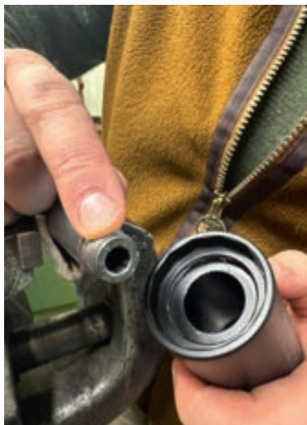
Korrosion am Lauf. Bei guter Pflege wäre das nicht passiert
