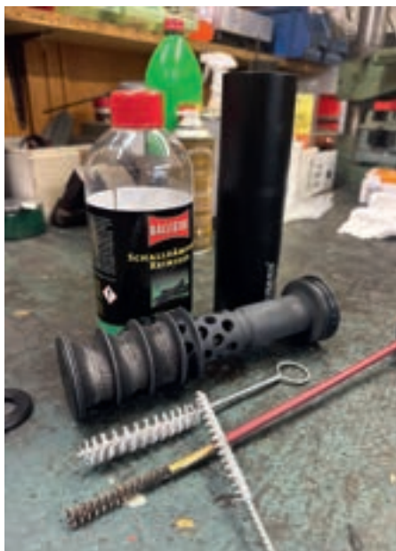
Die Verschmutzung am Schalldämpfer ist deutlich zu erkennen
